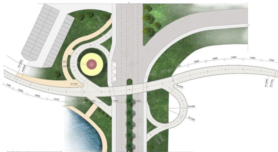
Рисунок 46. План пешеходного моста через дорогу
