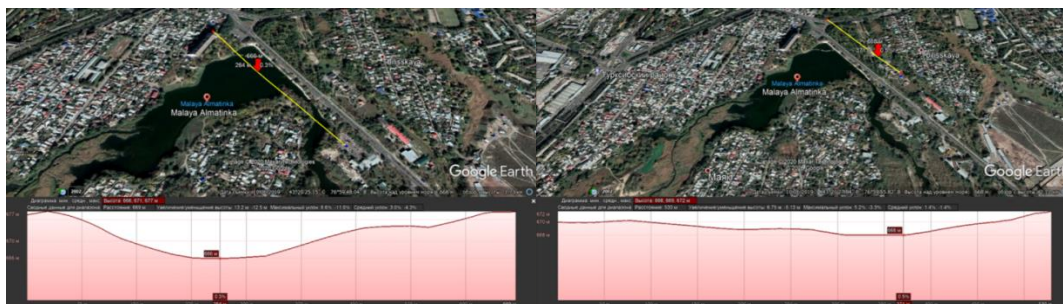
Рисунок 39. Поперечный профиль набережной озера и устья реки
